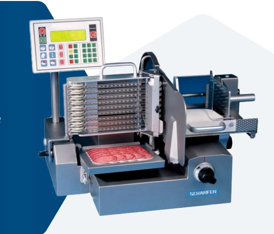
Esta máquina es apta para cortar casi cualquier tipo de alimento, es completamente automática con variador de velocidades, y cuenta con una altura máxima de apilado de 80 milímetros. Brinda la posibilidad de elegir entre 99 programas de corte (PLU), y todos los datos necesarios para el corte, como la designación del artículo, la velocidad de corte, el grosor del corte y todos los parámetros de apilamiento, pueden almace narse en el sistema para cada tipo de producto.
